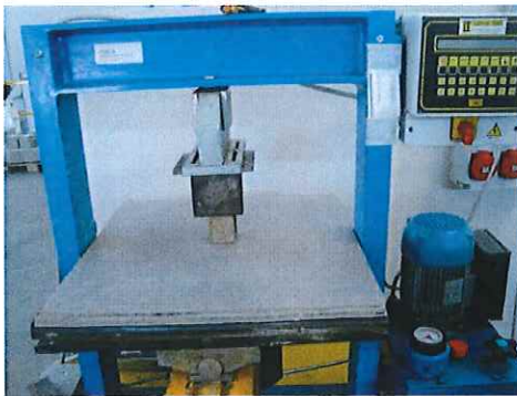
Dettaglio di prova e di rottura del campione
